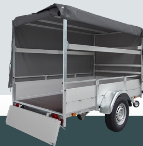
La bâche Anssems originale est faite d'un cadre robuste en acier avec des ridelles de support en aluminium.
